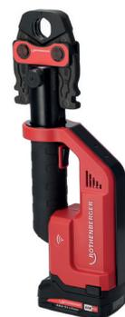
Pressbacken kompatibel mit dem Rothenberger RBT-1402 Standard-Pressmaschine
